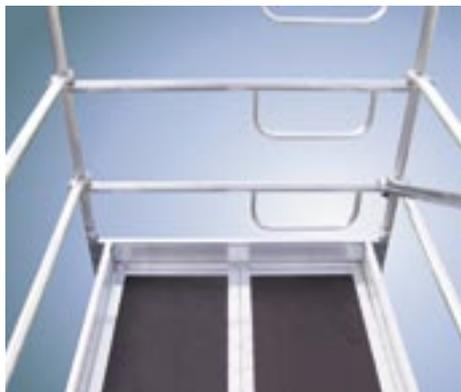
Posizionamento dei pannelli di calpestio in qualsiasi posizione nel ponteggio, con possibilità di formare il regolare doppio parapetto a 100 e 50 cm di altezza come da normativa vigente
